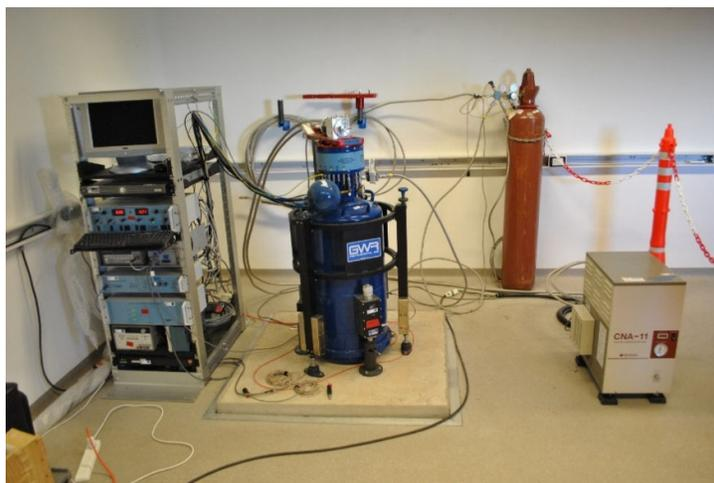
**Figura 1:** El gravímetro superconductor SG038 instalado en AGGO.
