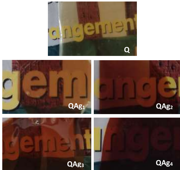
Figura 2.15. Fotografías mostrando la legibilidad decreciente de un texto ubicado detrás de películas de quitosano y de las matrices nanocompuestas formuladas con quitosano y nanopartículas de plata con concentraciones crecientes.
