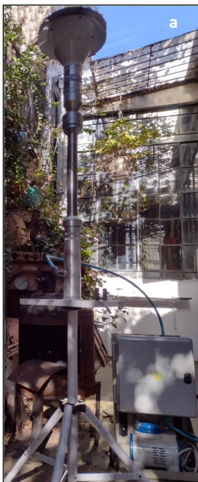
Figura 7.23. (a) Muestreador TDA. Fotografías de mallas fibrosas PVA-PVPCu 2 obtenidas por electrohilado (b) antes del comienzo y (c) una vez concluido el proceso de monitoreo.
