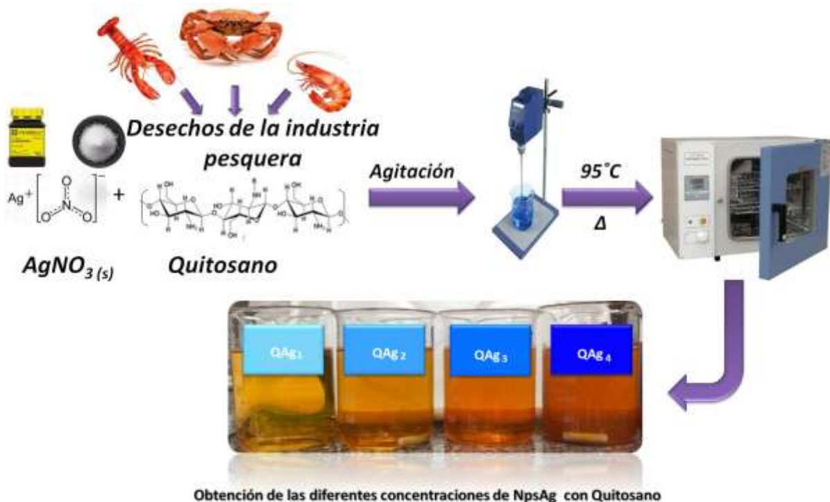
Figura 2.3. Esquema de síntesis verde in situ de nanopartículas de plata a partir de AgNO_3 y quitosano como agente reductor.
