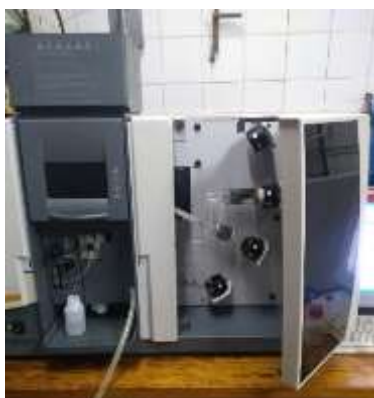
Figura 4.26. Espectrofotómetro de llama Varian AA240
