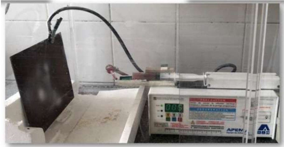
Figura 7.5. Dispositivo experimental mostrando la fuente de alta tensión, la bomba infusora y la placa colectora utilizada para producir fibras mediante el proceso de electrohilado.
