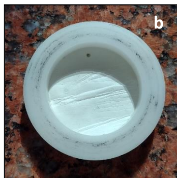
Figura 7.23. (a) Muestreador TDA. Fotografías de mallas fibrosas PVA-PVPCu 2 obtenidas por electrohilado (b) antes del comienzo y (c) una vez concluido el proceso de monitoreo.
