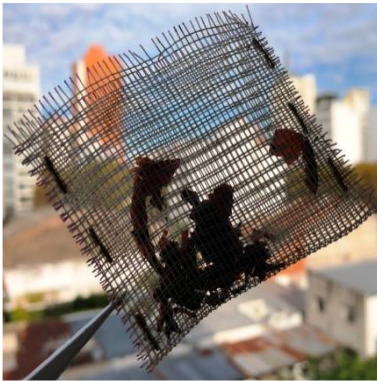
Figura 9.13. Morfología superficial de las películas de QCu a lo largo del período de ensayo. En las fotografías se observa el deterioro de la superficie, el cambio de coloración y la pérdida de masa con el progreso del proceso de degradación.
