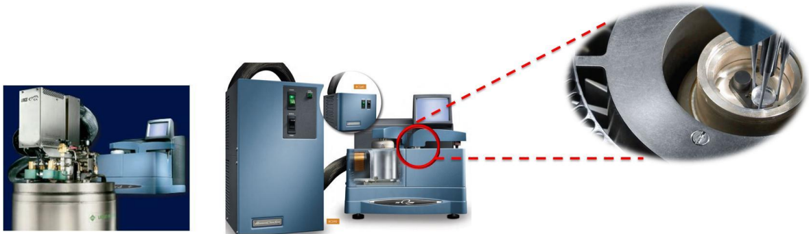
Figura 22. Imágenes del calorímetro diferencial de barrido (DSC) utilizado acoplado a un sistema de enfriamiento de N 2 líquido. Se muestra el horno del equipo donde se ubica la cápsula sellada con la muestra y el patrón de referencia. Adaptado de TA Instruments (2016) .
