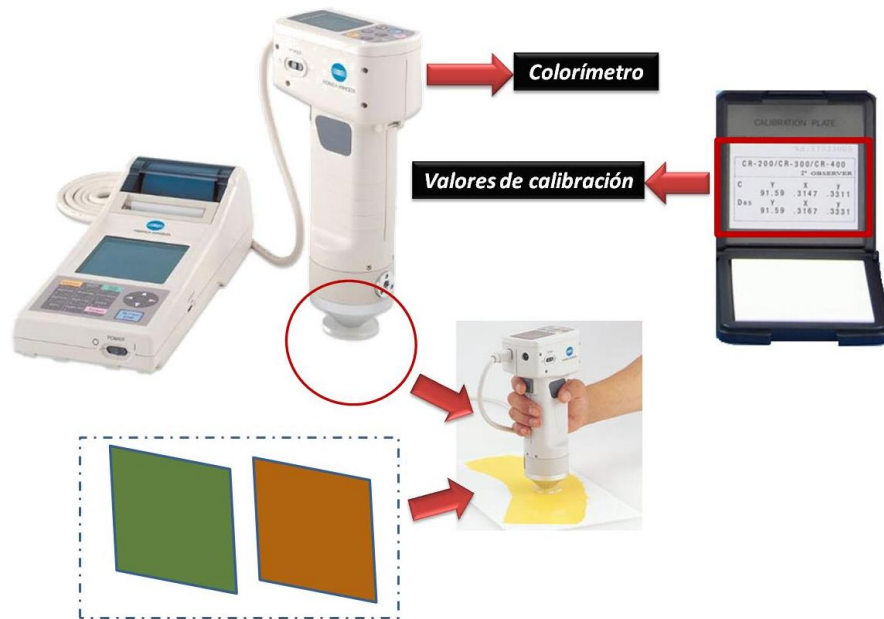
Figura 7. Imagen del equipo Minolta Serie CR 300 (Osaka, Japón) utilizado para medir las propiedades ópticas de color en las películas formuladas.
