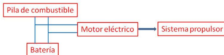
Figura 11: Sistema híbrido serie con pila de combustible
