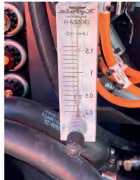
Vesisyöttö märkäporauksessa 0,4 l/min, säiliön koko 40 l
