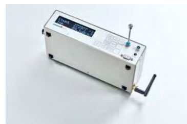
Kuva 3. Pölyjakeiden vaihtelu suoraan osoittavalla laitteella mitattuna (yllä) ja ko. laite (alla; Grimm, Grimm Technologies).
