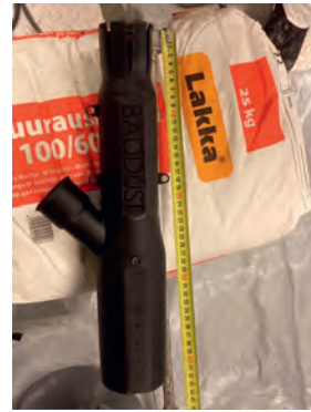
Kuva 6. Sekoittajaan liitettävä huuva.
