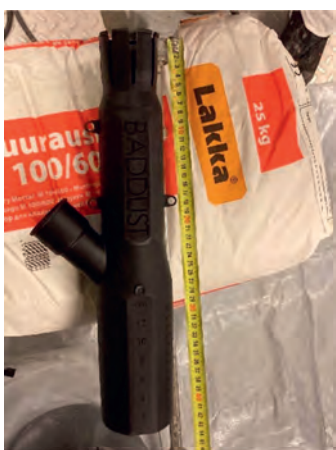
Kuva 2. Sekoittajiin suunniteltu laitekohtainen kohdepoisto (huuva).
