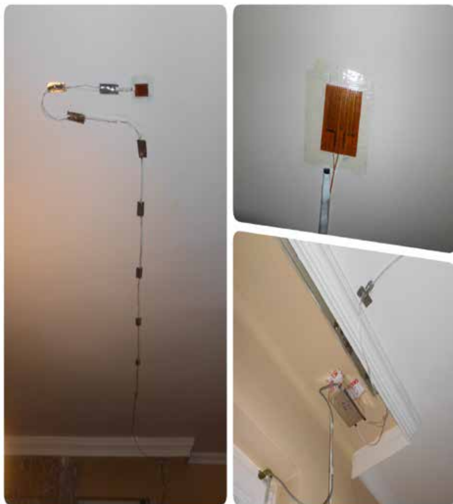
3. ábra: Higrotermikus monitoring rendszer kialakítása a hajdúnánási családi ház padlásfödéme alatt a belső térben
