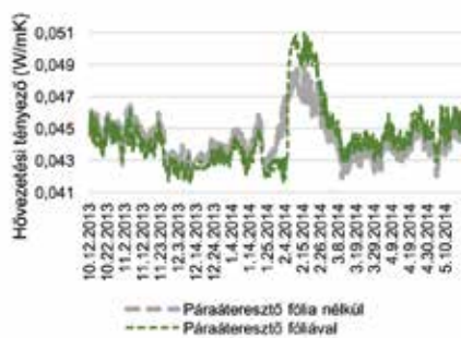
8. ábra: Hővezetési tényező, illetve a hővezetési tényező a relatív páratartalom függvényében a tetőszerkezet esetén
