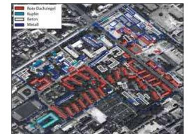
Abb. 4: Beispiel von automatisch detektierten Gebäudeumrissen mit unterschiedlichen Dachmaterialien
