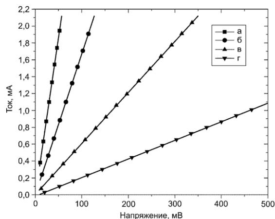
Рис. 3. ВАХ запрограммированных током 5 мА антипрожигаемых перемычек: а – Me/N/Me; б – Me/a-Si/Me; в – Me/NON/Me; г –  $n^+$ -Si/ONO/ПКК
