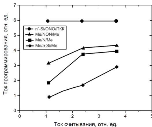
Рис. 6. Отношение тока нарушения запрограммированного состояния к току программирования в зависимости от типа структуры антипрожигаемой перемычки. Закорачивающие мостики из поликремния менее чувствительны к нарушению запрограммированного состояния
