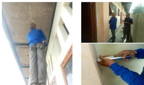
Gambar 4. Pengujian dengan *Hammer Test*
