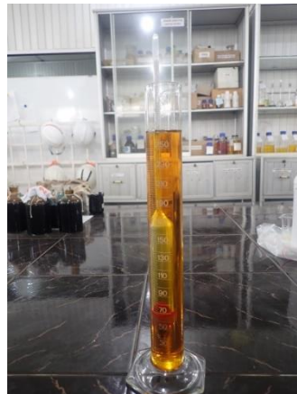
Gambar 4. Proses pengamatan hydrometer pada bahan bakar cair
