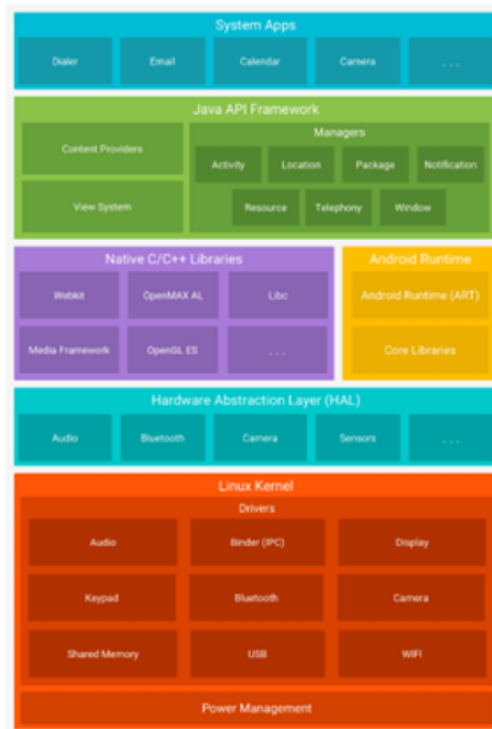
Ilustración 8 ESTRUCTURA DE ANDROID
