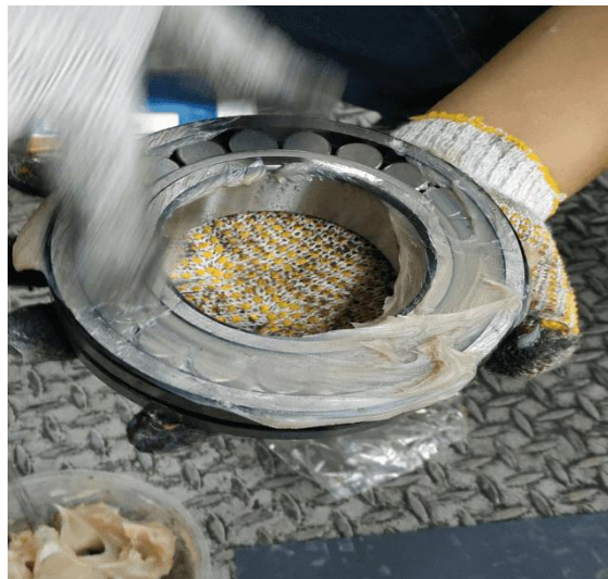
Gambar 5. Proses Pelumasan Bearing Menggunakan Grease
