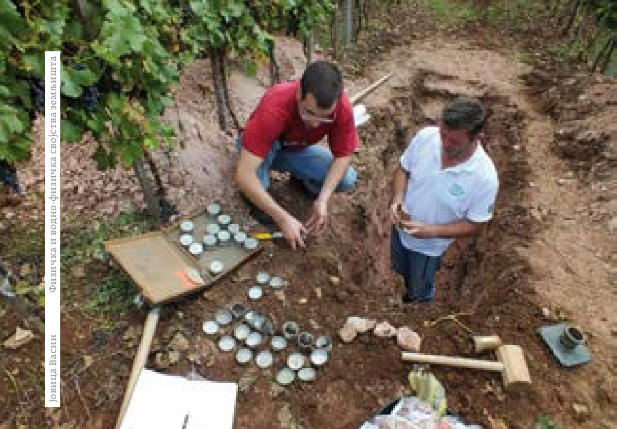
Слика 11: Узорковање земљишта у неповремењеном стању цилиндрима по Копецком (Корецку)
