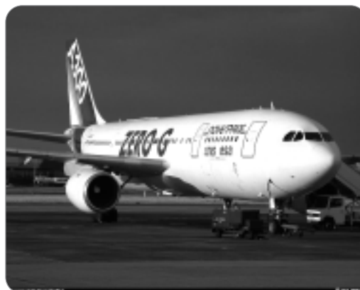
Figura 5 L'Airbus A-300 Zero-g utilizzato per i voli parabolici dell'ESA
