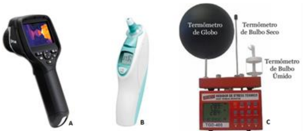
Figura 1 - Instrumentos utilizados para a coleta de dados. A) Câmera infravermelha Flir. B) Termômetro auricular. C) Medidor de Stress Térmico.
