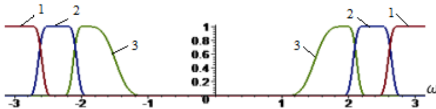
Рис. 2. Графики модулей частотных функций H^{10}(\omega) (линия 1), H^{11}(\omega) (линия 2) и H^{12}(\omega) (линия 3) Fig. 2. Plots of moduli of frequency functions H^{10}(\omega) (line 1), H^{11}(\omega) (line 2) and H^{12}(\omega) (line 3)
