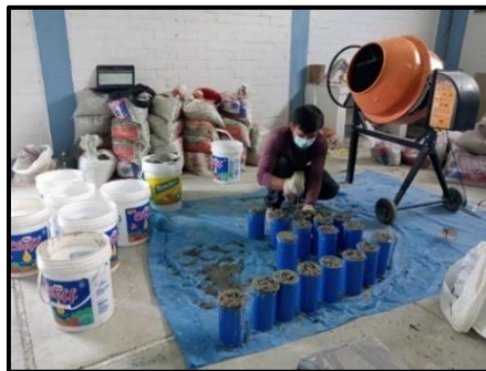
Apisonado de la segunda capa en la fabricación de las probetas
