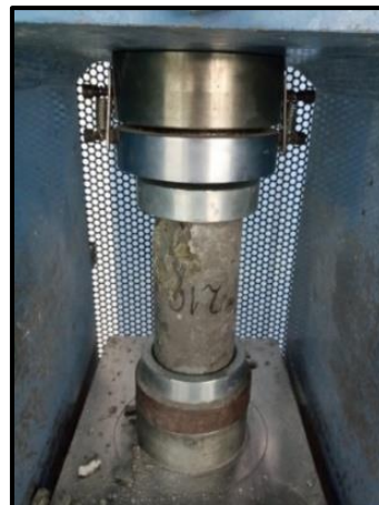
Falla de probeta sometida a esfuerzo
