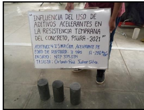
Identificación de probetas antes de ensayo
