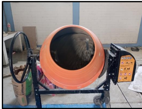
Mezclado de materiales del concreto
