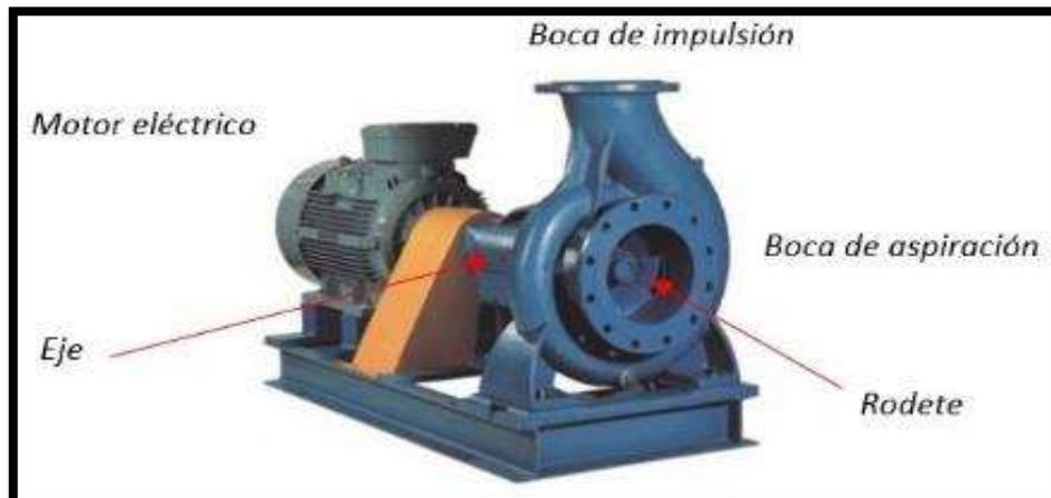
*Figura 5 - Bomba Centrífuga*
