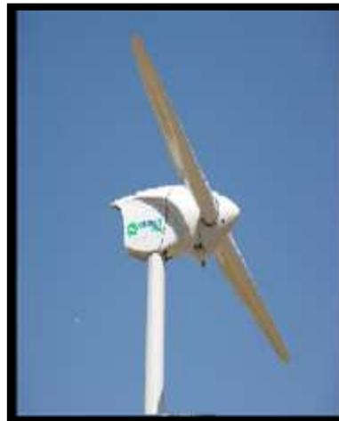
*Figura 31 - Aerogenerador Eje Horizontal a dos Palas*
