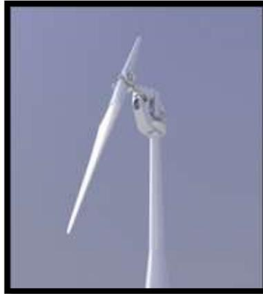
*Figura 30 - Aerogenerador Eje Horizontal a una Pala*
