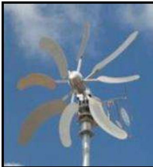
*Figura 33 - Aerogenerador Eje Horizontal Múltipalas*
