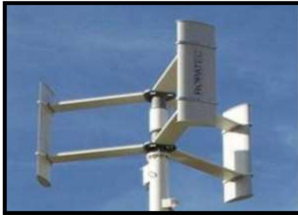
*Figura 25 - Aerogenerador Darrieus tipo H o Giromill*
