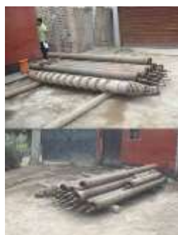
Ilustración 1: Bomba desmontada en mantenimiento
