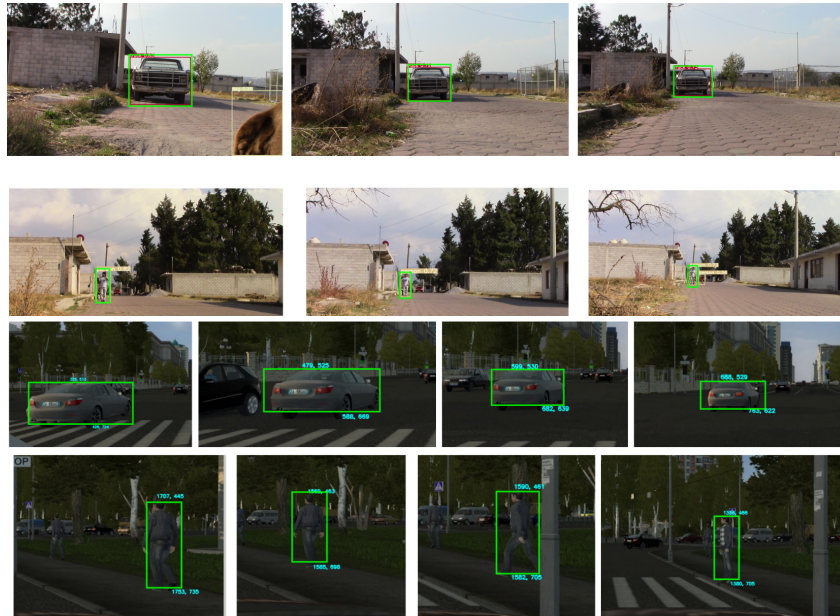
Figura 4.4. Muestras para realizar las mediciones de altura (pixeles) de peatones y vehículos vs la distancia real a la que se encuentran, tanto en ambientes reales como del simulador city car driving .
