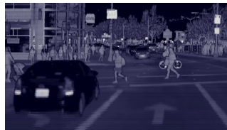
Figura 2.3. Reconstrucción del ambiente mediante nube de puntos del escaneo de un sensor lidar, tomado de Waymo, 2021 ( https://waymo.com/intl/es/waymo-driver/ ).
