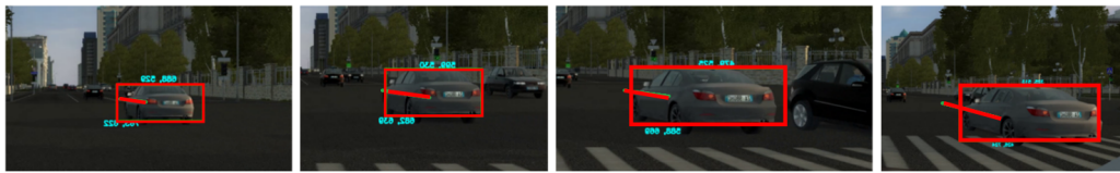
Figura 5.6. Secuencia de frames para la estimación de cambio de dirección de un obstáculo (automóvil) detectado en un ambiente virtual.
