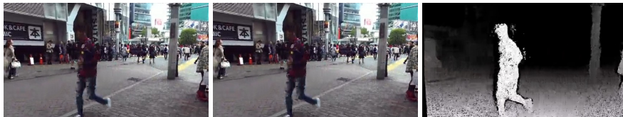
Figura 2.6. Frame original y reconstrucción de la escena en un mapa de disparidades, tomado de StereoLabs, 2021 ( https://www.stereolabs.com/developers/ ).
