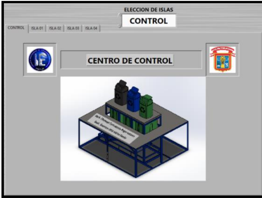
Figura 47 Panel menú principal en centro de monitoreo y control
