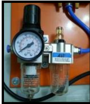
FIGURA 12 Unidad de mantenimiento
