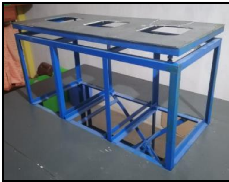
Figura 26 Plataforma elevadiza del contenedor soterrado
