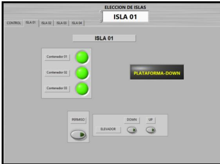
Figura 46 Panel de monitoreo y control
