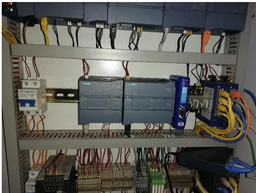
Figura 104: Módulos PLC S71200, utilizados para la demostración del proyecto de tesis.
