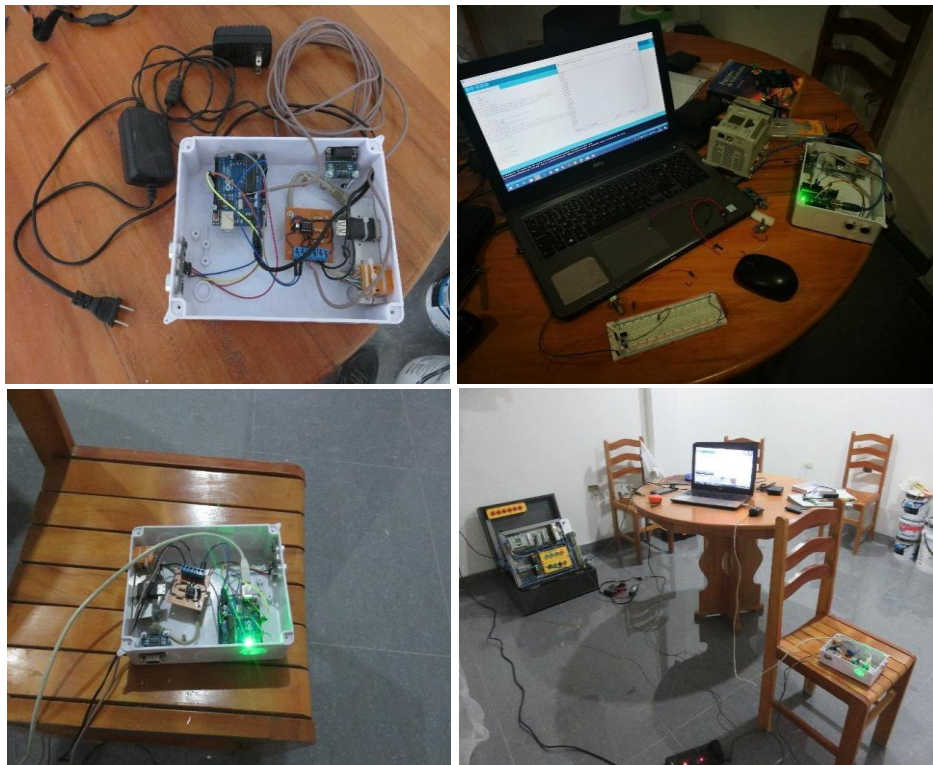
Figura 123. Toma Fotográfica de las pruebas realizadas en el sensor ultrasónico con la etapa de acondicionamiento de señal, Calibración del sensor: 0 a 10VDC/ 0 a 300cm.
