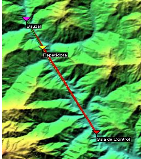
Figura 46. Trazado de Radioenlaces en Radio Mobile, Enlace factible (color verde); enlace no factible (color rojo).
