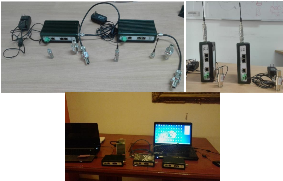
Figura 106. Toma Fotográfica de las radios Modem's, utilizadas para las pruebas de transmisión de datos.
