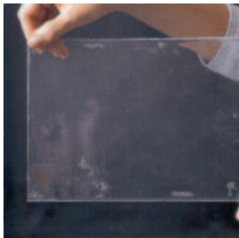
Figg. 7, 8, 9. Vetri termocromici. Ancora in fase di sperimentazione, i vetri termocromici sfruttano la caratteristica dei materiali trasparenti di modificare le proprietà ottiche in funzione della variazione di temperatura. La reazione chimica è di tipo reversibile una volta ripristinate le condizioni termiche entro le quali è statica la reattività chimica. Lo studio applicativo di questa tipologia di vetri appartenenti alla più ampia famiglia dei vetri cromogenici come elementi applicati all'involucro architettonico, è innovativo in quanto prevede l'esposizione delle due facce (interna ed esterna) a condizioni termiche differenti.
