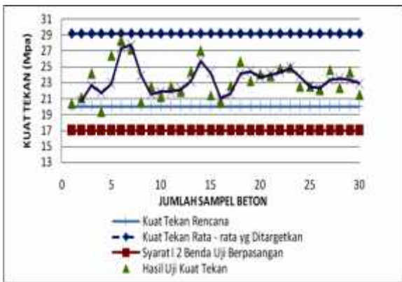
Gambar 3. Grafik Hasil Kuat Tekan Silinder Beton Normal f'_c 20 Mpa dengan Nilai Slump 60 mm
