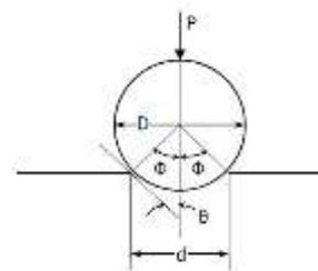
Gambar 2. Parameter-parameter dasar pada pengujian Brinell (Dieter, 1988)
