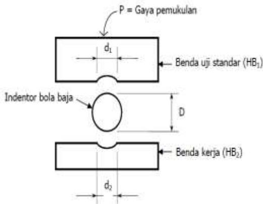
Gambar 3. Skema pengujian kekerasan Brinell Palu Poldy
