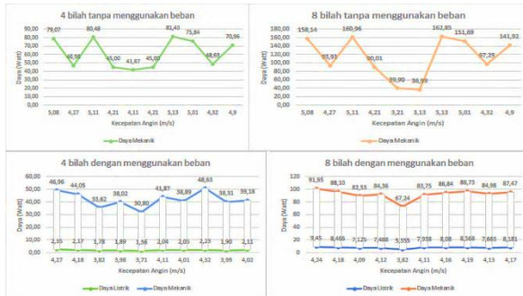
Grafik 4.3 Perbandingan Daya listrik dan Daya Mekanik Angin pada Turbin menggunakan 8 sudu dan 4 sudu
