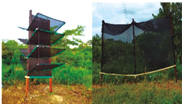
**Figura 4.** Prototipos de captación de la niebla construidos tipo pantalla y tipo árbol.
