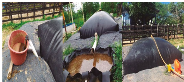
Figura 6. Biodigestor Construido con sus partes (Tina de alimentación, Reactor, tina de biol y Línea de Biogás).
