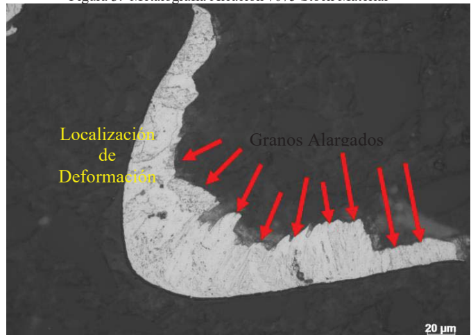
Figura 4. Metalografía Aleación 7075 Viruta 20\mu\text{m}
