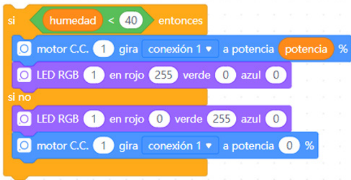
Figura 3. Módulo de control de humedad del suelo.
