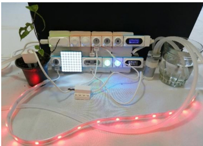
Figura 6. Prototipo de sistema de control de invernadero
