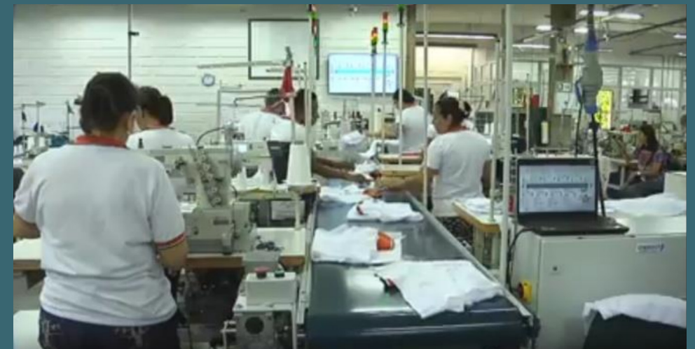
Figura.4. Banda transportadora, Tablero de control y Aula Semiautomatizada implementada
