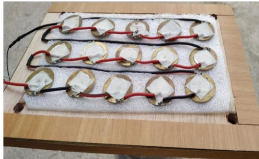
Figura 8. Base Inferior con el circuito principal de generación de energía. Fuente: Elaboración propia (2019)
