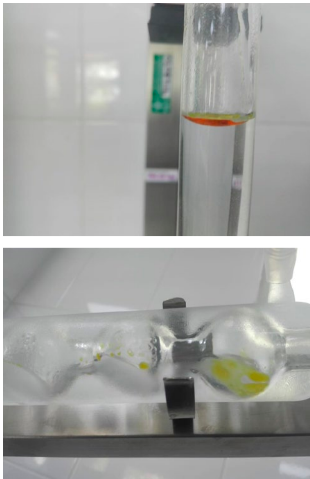
Figuras 1 y 2. Tubo de condensación y muestra de aceite de 0,6 ml, obtenida en el proceso de hidrodestilación
