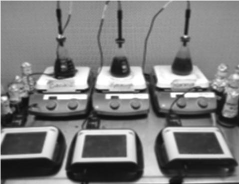
**Figura 2.** Montaje de fermentación para medición de % etanol en atmósfera.
