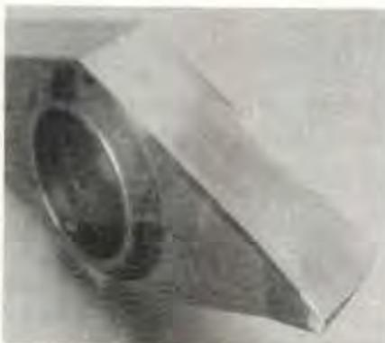
Figura 4a. Herramienta de corte recubierta con TiAlN
