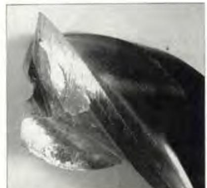
Figura 4c. Broca desgastada por adhesión de material [4]
