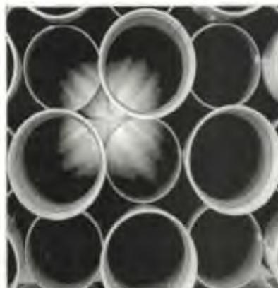
Al usar sistemas estabilizantes con base orgánica, es posible fabricar tubos de diámetros hasta de 600 mm.
