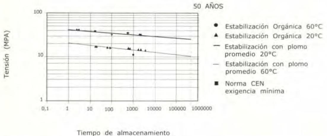
Figura 3. Presión de reventamiento en tubos con diámetro de 110 mm, según ISO 1167
