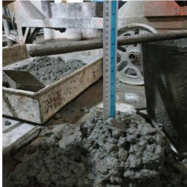
Gambar 3 Hasil pengukuran *slump*
