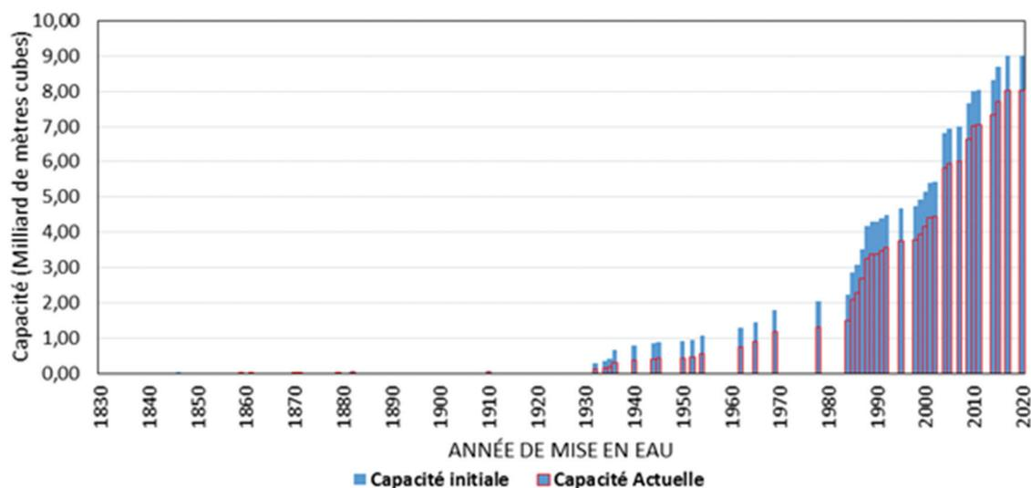
Indépendamment du changement climatique, l'envasement des retenues des barrages reste le souci majeur pour leur conservation. Ce phénomène est bien sûr pris en compte lors de la conception du barrage. Une tranche dite morte qui vient en plus de la capacité utile nécessaire à la régularisation interannuelle est prévue pour 30 à 50 ans d'exploitation. Il n'en demeure pas moins qu'à long terme se pose le problème de conservation des retenues de stockage de la ressource en eau.
