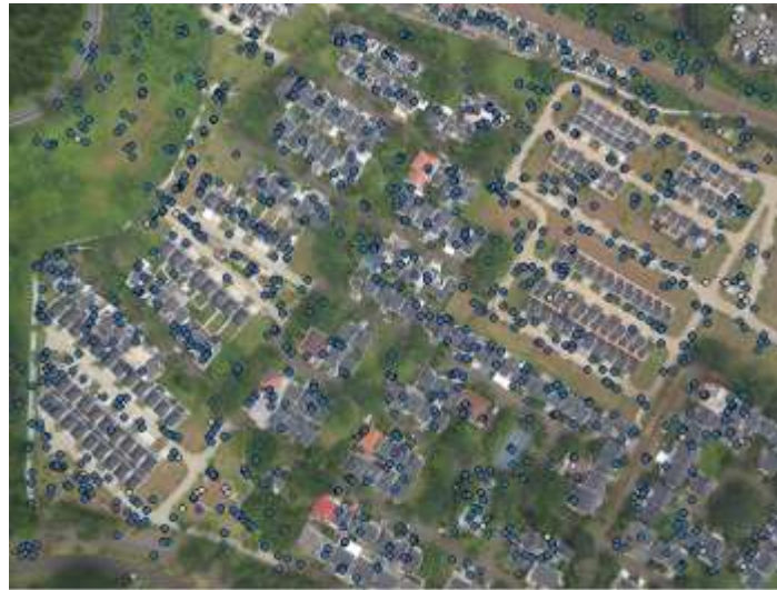
Gambar 3. 1 Distribusi tie point pada foto
