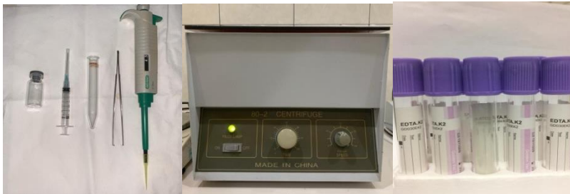
Gambar 3: Dari Sebelah Kanan: Tabung Ungu EDTA, Alat Alat Sentrifugasi, Mikropipet, Pinset, Tabung Reaksi, S spuit, dan Vial.
