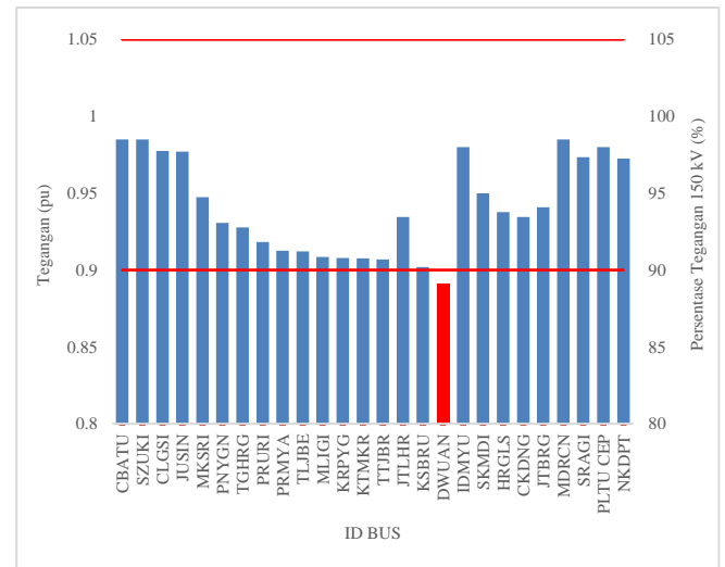
Gbr. 10 Grafik kondisi tegangan sebelum penempatan STATCOM
