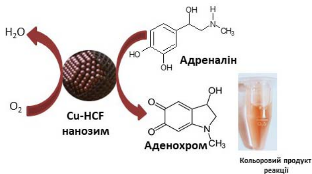
Рис. 3. Схема реакцій, що лягла в основу методу визначення АД за використання Cu-NCF НЗ – міметика природної лаккази
