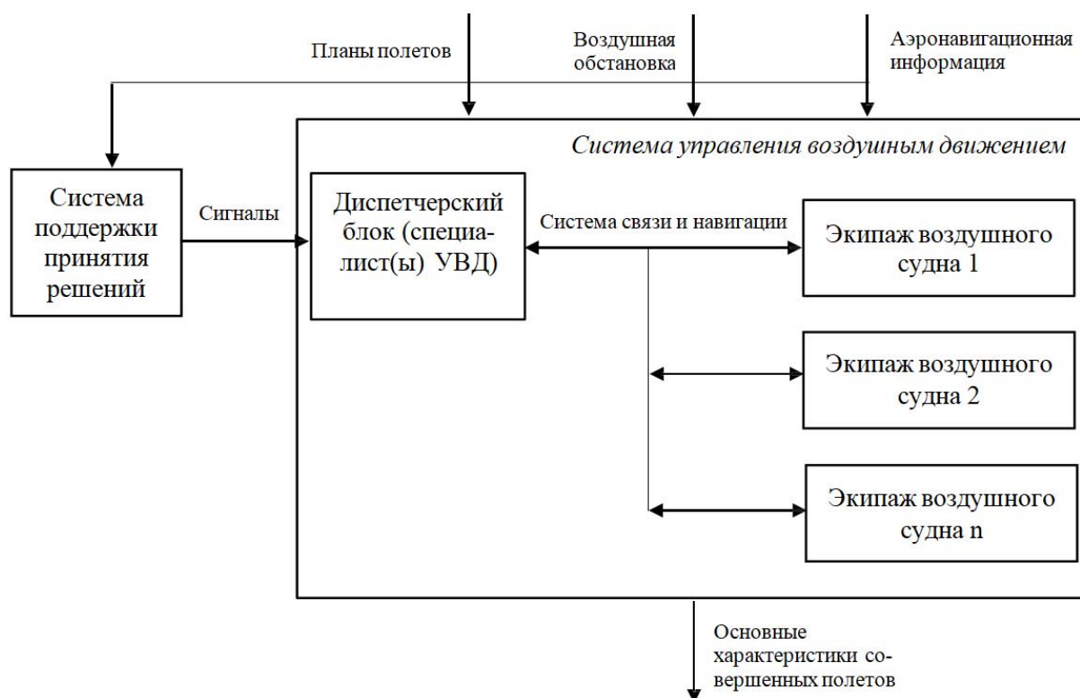
Рис. 1. Упрощенная схема функционирования подсистемы непосредственного управления системы УВД Fig. 1. Simplified subsystem operation diagram of the direct control of the ATC system
