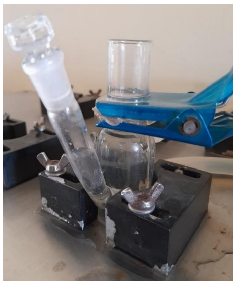
Fig: 17; Franze diffusion apparatus
