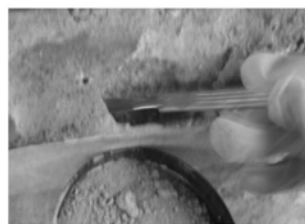
Poverizzazione della malta originale incoerente
