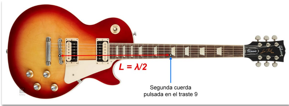
Ilustración 3 - Sección de una cuerda oscilante en una guitarra eléctrica
