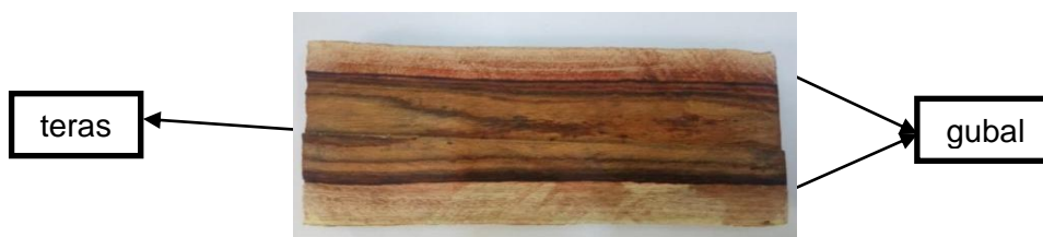
Gambar 3. Corak kayu teras dan gubal sonokeling dengan penampang radial (foto diambil menggunakan mode original/ tanpa efek).
