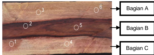
Gambar 2. Titik-titik pengukuran warna kayu dan perubahan warna kayu sonokeling pada penampang radial.
