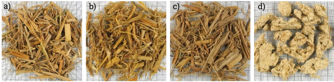
Abbildung 4-12. Optischer Eindruck von Reisstroh a) im Originalzustand und nach der chemischen Aktivierung mit b) Phosphorsäure, c) Zinkchlorid und d) Kalilauge
