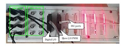
Fig. A.4. DSPACE 1104 interface board.
