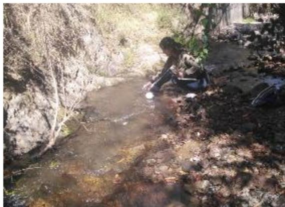
3. En la imagen podemos apreciar el tecnopor de 3" pulgadas de diámetro para realizar los ensayos y calcular el caudal en tiempos de estiaje.
