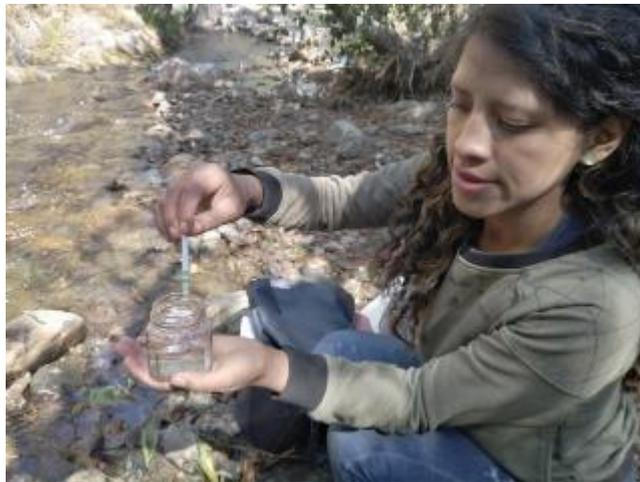
8. En la imagen se muestra la toma del pH de la fuente.
