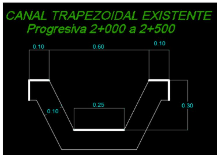
Figura N° 32: Dimensión del Canal trapezoidal existente.
