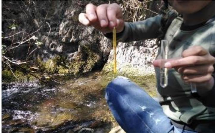
10. En a la imagen se muestra el termómetro para toma de la temperatura del agua.
