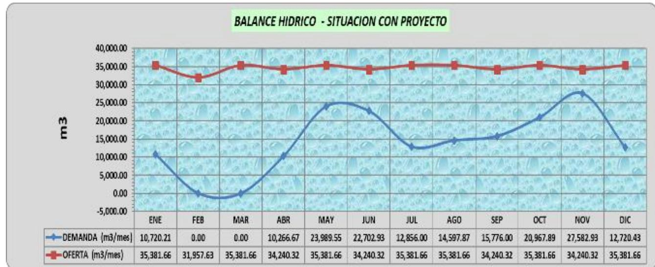
Figura N° 27: Diagrama de balance Hídrico con proyecto.
