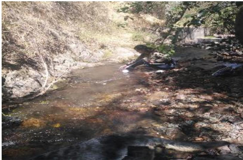
Figura N° 11: Cálculo del caudal por el método del Flotador.
