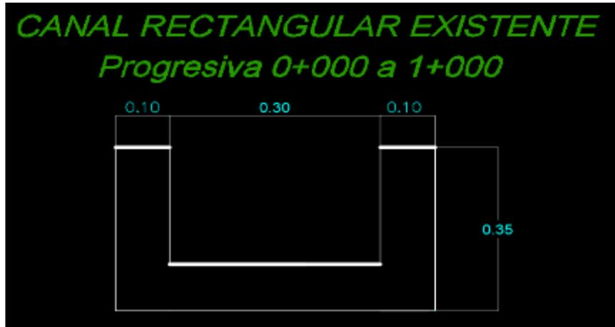
Figura N° 29: Dimensión del Canal rectangular existente.
