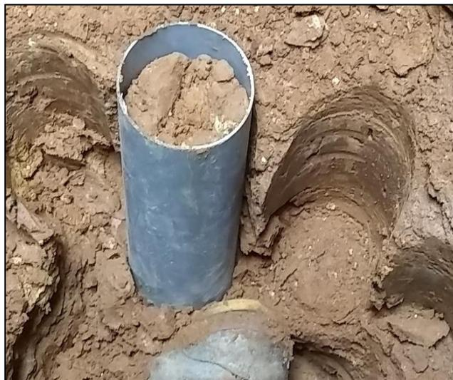
Figura 18. Vista de las muestras extraídas en la calicata N°03
