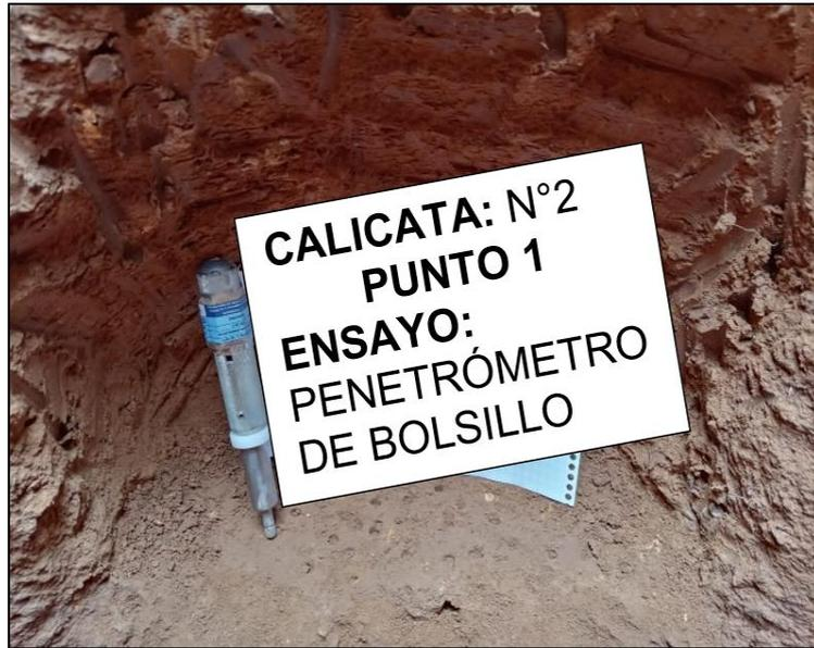
Figura 15. Ensayo de penetrómetro de bolsillo en la calicata N°02.
