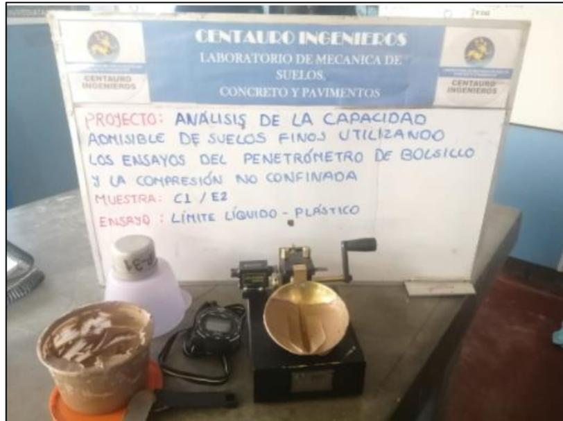
Figura 23. Ensayo de límite líquido del suelo arcilloso.
