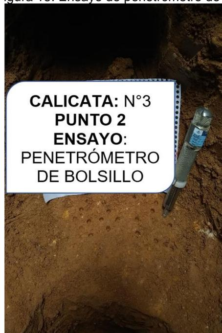
Figura 16. Ensayo de penetrómetro de bolsillo en la calicata N°03.
