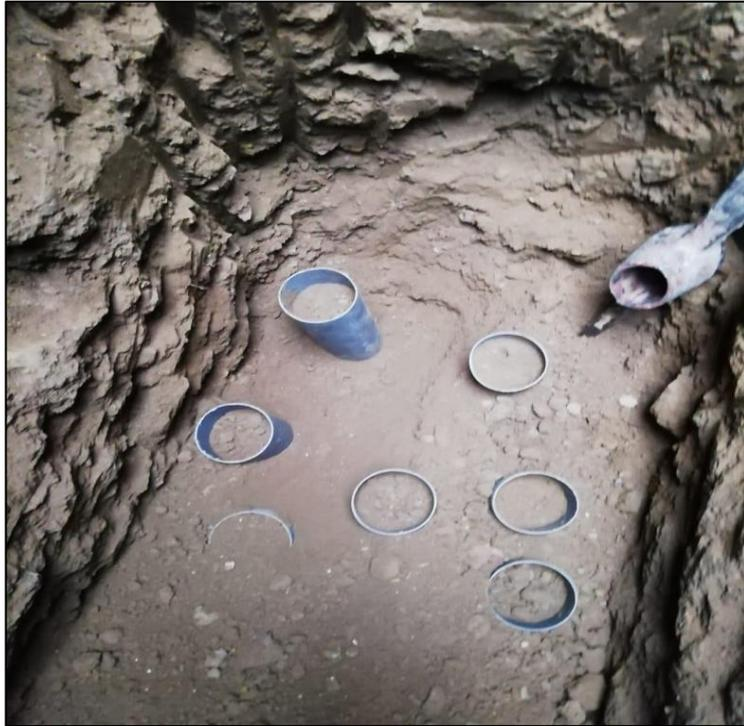
Figura 17. Extracción de muestras en la calicata N°01.
