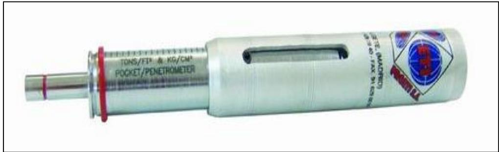
Figura 11. Penetrómetro de bolsillo
