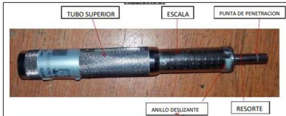
Figura 12. Partes del penetrómetro de bolsillo.
