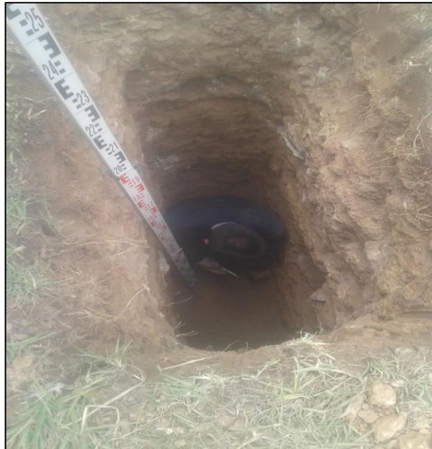
Figura 14. Realización del ensayo de penetrómetro de bolsillo en la calicata N°01.
